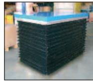
Fuelle de seguridad
