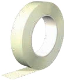
**Cinta de carrocero de alta calidad**, con un grosor de 110 micras, fabricada con papel crepé recubierto de aceite de silicona por un lado y de adhesivo acrílico a base de agua por el otro.
