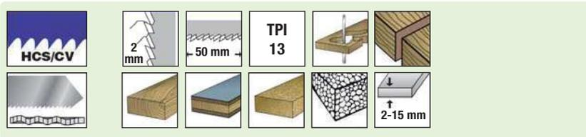
Dentado fresado y ondulado. Corte curvo y limpio en madera blanda, madera contrachapada, tabla de viruta prensada, madera estratificada, tablero de fibra y materiales de aislamiento.
