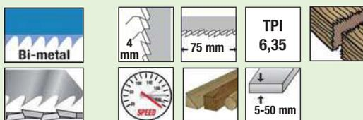
**Dentado alterno y afilado diagonal. Corte rápido en todo tipo de maderas. Alto rendimiento.**
