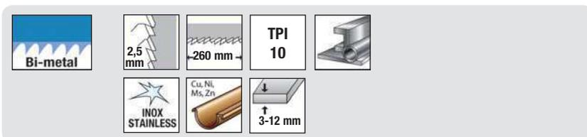
**Dentado fresado y ondulado. Sierra flexible y universal para aceros, inoxidable y metales no ferrosos.**
