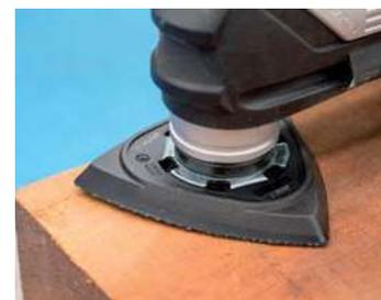
**Placa para pulir con fijación tipo micro-velcro.**
