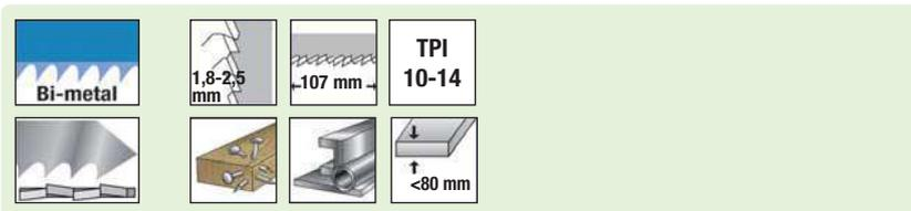
Dentado fresado alterno. Sierra larga y flexible para madera con residuos de metal, tubos y perfiles de acero (2,5-10 mm). Gran rendimiento.
