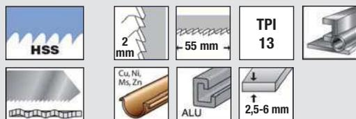
**Dentado fresado y ondulado. Aceros, metales no ferrosos y aluminio.**
