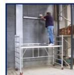
Andamio de aluminio de base plegable, de fácil montaje y transporte. Móvil y compacto, para alcanzar alturas de trabajo de hasta 8,80m. Plataforma de 60x178 cm. Incluye ruedas con freno. Paquetes de extensión adicionales. Fabricado según norma EN 1004 clase 3 (200 kg/m<sup>2</sup>). Con certificado de homologación. A partir de 14330 lleva rodapiés.
