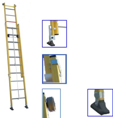
Escalera de dos tramos unidos mediante abrazaderas cuyo deslizamiento se produce mediante polea y cuerda. Zapatas giratorias antideslizantes, ruedas de goma blanca para facilitar su deslizamiento sobre las paredes. El primer peldaño y el último son macizos. Peldaños de 30 mm con corrección de inclinación. Fabricada según norma UNE-EN 131. *Conforme el ensayo eléctrico 6.5.1. de la norma EN 61478: 2002. Trabajos en tensión escalera de material aislante. Tensión de ensayo 91 KV.*
