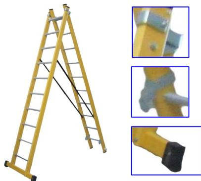
Escalera aislante de fibra de tijera o extensible manual, cintas anti-apertura de seguridad, estabilizador con tacos de goma. Peldaño de 30mm con corrección de inclinación. Fabricada según norma UNE-EN 131. *Conforme el ensayo eléctrico 6.5.1. de la norma EN 61478: 2002. Trabajos en tensión escalera de material aislante. Tensión de ensayo 91 KV.*
