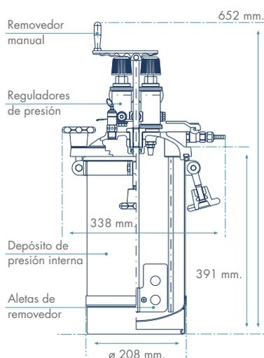
Ofrece la máxima robustez con el cuerpo y la tapa fabricado en acero inoxidable.
