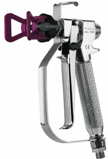
Pistola airless de alta presión con cuerpo de aluminio estampado y anodizado. Gatillo de 4 dedos para mayor comodidad de uso. Tanto los asientos como los cierres están fabricados en Carburo Tungsteno. Incorpora racor giratorio de 1/4" M. Aplicación de pinturas pásticas con extensión rodillo.
