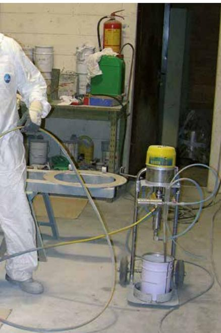
Bomba mixta ideal para acabados en alta producción, de sencillo manejo y alta robustez. Reducido mantenimiento y sistema de autoajuste de empaquetaduras.
