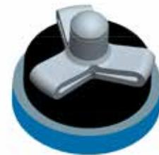
La versión S-Trébol proporciona una resistencia adicional tanto a tracción como a cizalladura y se puede utilizar en taladros sobredimensionados debido a que su expansión es adaptable. Además posee una arandela de neopreno que proporciona excelentes resultados de estanqueidad. El remache BRALO S-Trébol cuenta con la aprobación del DIBt (Deutsches Institut Für Bautechnik).
