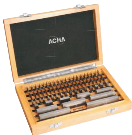
ESTUCHE CON JUEGO DE 47 BLOQUES PATRÓN DE ACERO DIN 861 UNE EN ISO 3650
